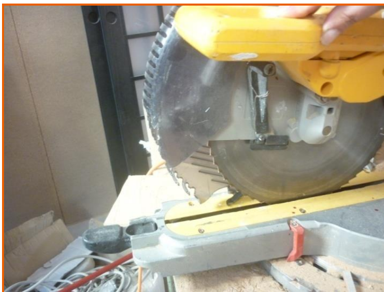
Figura 3: la cuffia di protezione della troncatrice era parzialmente rotta nel tratto inferiore e lasciava scoperta un tratto della lama.
