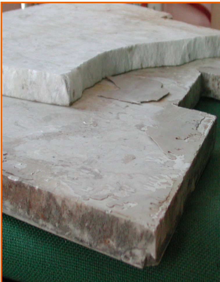
Lastre di travertino e marmo sovrapposte, utilizzate per la copertura della botola dell'edicola funeraria
