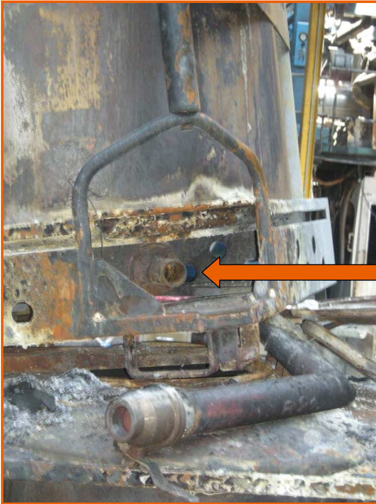
Imbocco della cisterna privo della valvola
