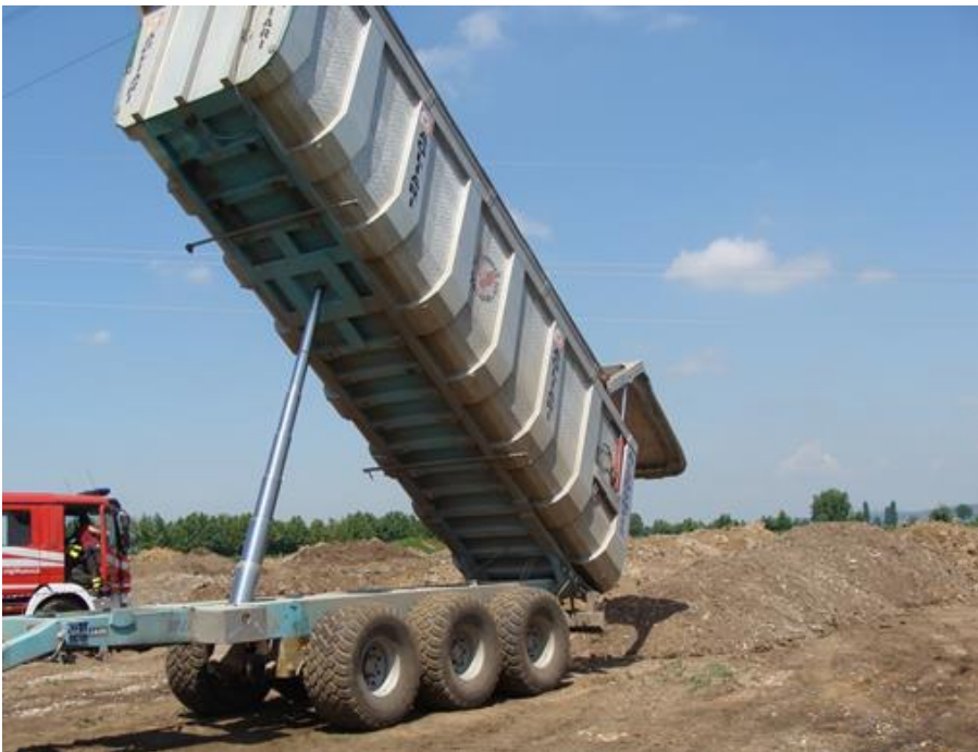
Figura 1: posizionamento del ribaltabile poco dopo l'incidente. Sullo sfondo si notano i cumuli precedentemente scaricati da Andrea con la tecnica del contemporaneo innalzamento del cassone e avanzamento della motrice (nel caso di specie, un trattore).
