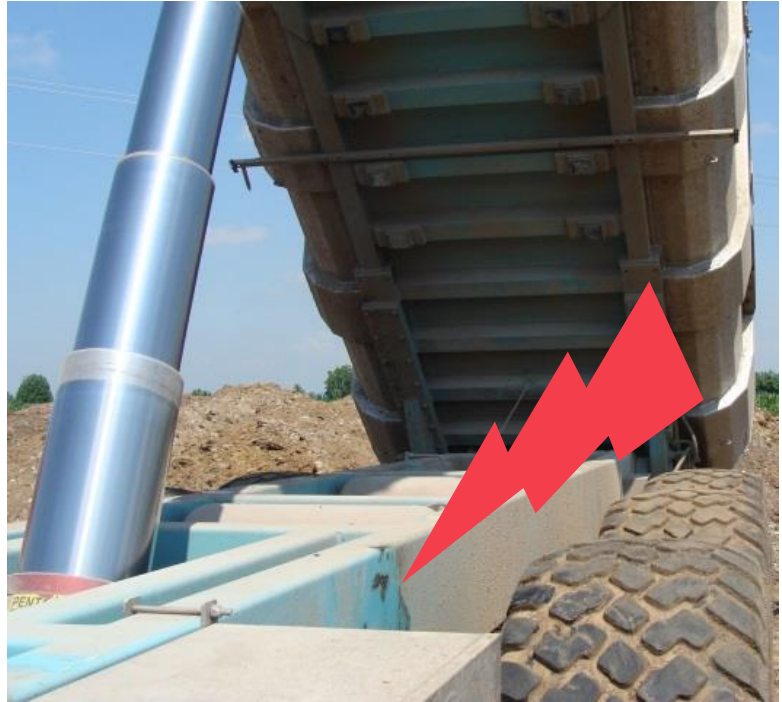
Figura 4: punto di contatto diretto tra il corpo del lavoratore e la parte metallica del cassone in tensione a causa del contatto con la linea elettrica aerea.
