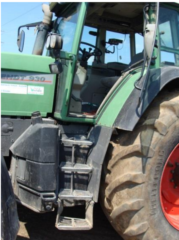
Figura 3: particolare degli scalini di accesso all'interno della trattoria. Il verosimile salto di Andrea gli ha evitato di venire a contatto con le parti metalliche del mezzo e la conseguente possibilità di folgorazione per contatto diretto di parti metalliche in tensione.
