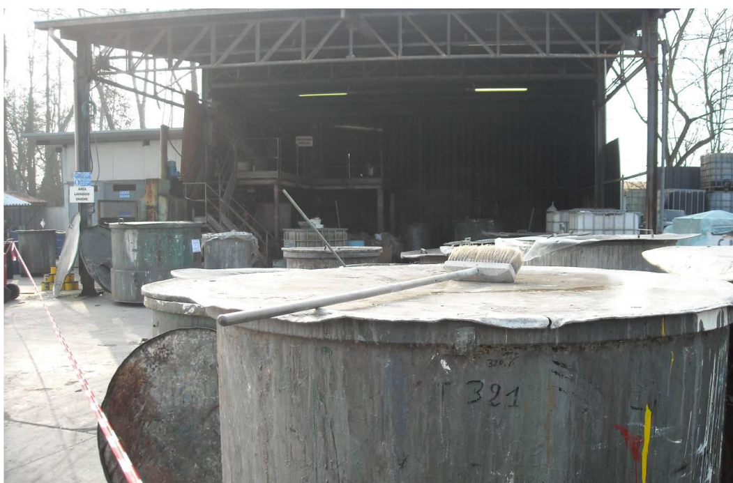
Figura 1: area lavaggio con vasche sia in attesa di lavaggio sia bonificate; in primo piano si nota una spazzola usata per il lavaggio manuale delle vasche
