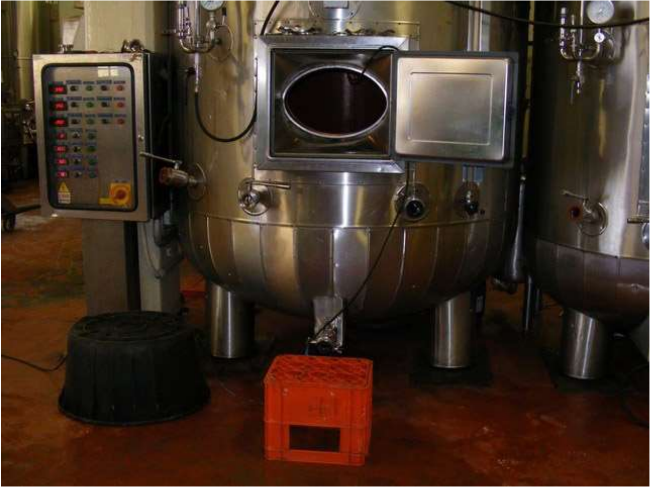
Figura 1: autoclave utilizzata per la fermentazione del vino
