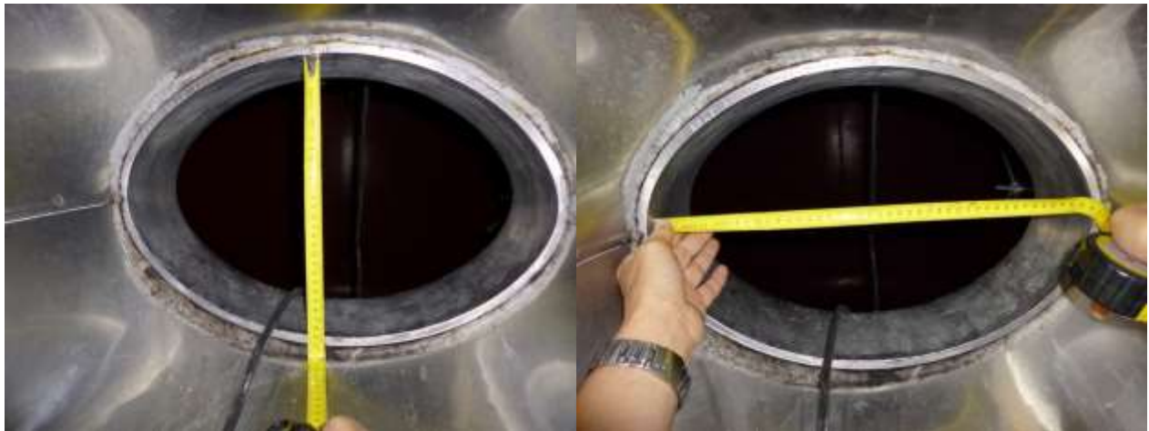
Figura 2: apertura ovale dell'autoclave "a passo d'uomo".
