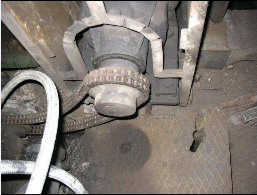
Linea 4, Torino: organi di trasmissione del moto accessibili
