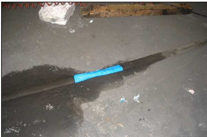
Linea 4, Torino: manichetta riparata con nastro adesivo
