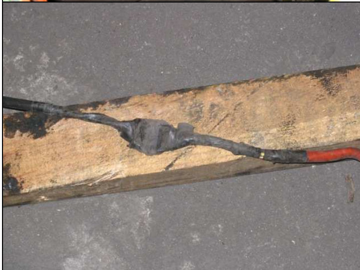
Linea 4, Torino: cavo elettrico nastrato e schiacciato
