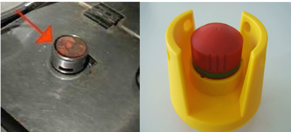
Immagini relative a pulsanti di emergenza sul pulpito principale della linea 5 (a sinistra) e tratte da cataloghi di produttori (a destra)
