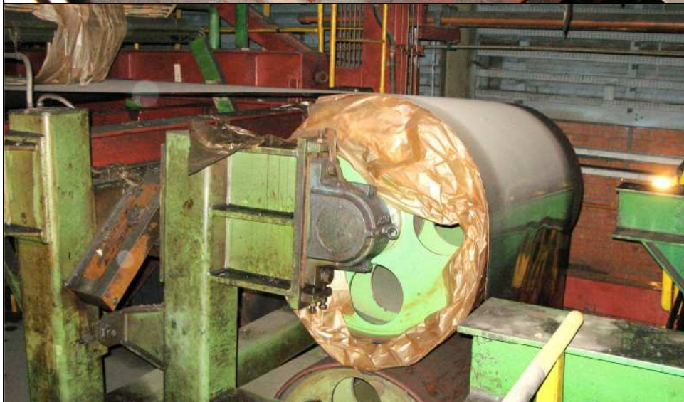
Linea 5, Torino: carta impressa sui rulli centratori a monte del carro di accumulo di ingresso e sul nastro in uscita dal carro verso la briglia 2
