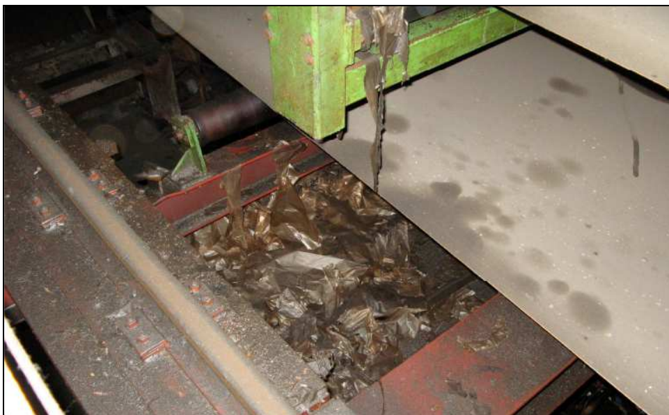
Linea 5, Torino: presenza di carta sul tetto della saldatrice
