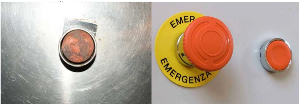
Immagine relativa a pulsanti di arresto e di emergenza e di arresto sulla linea 5 e estratte da cataloghi di produttori (a destra)
