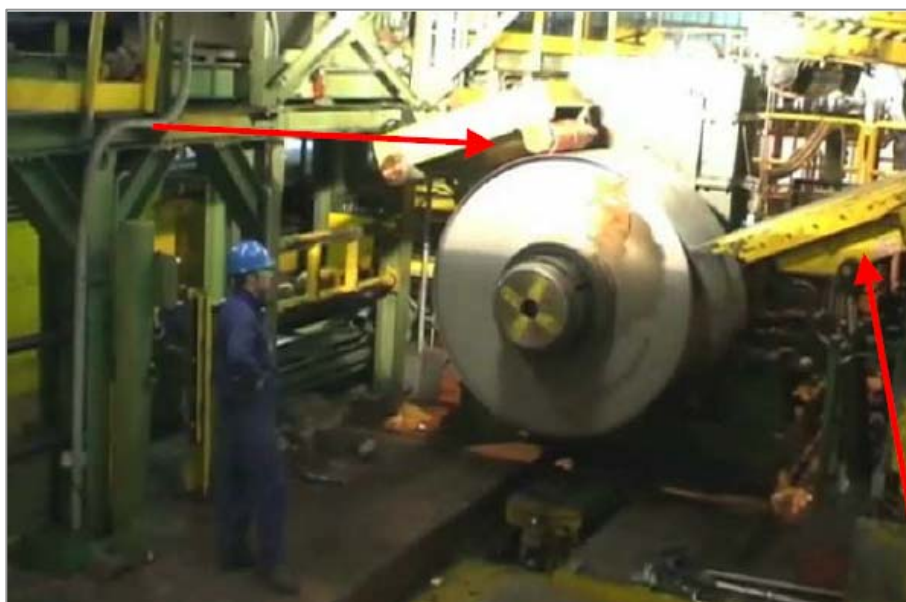
Figura 8: aspo svolgitore con tavola d'imbocco e rullo raddrizza piega
