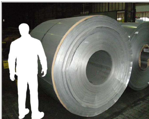
Figura 1: rotolo di acciaio (o coil) il cui diametro può raggiungere due metri
