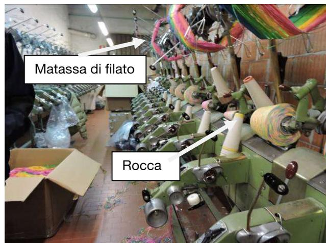
Figura 2: Macchina dipanatrice in funzione
