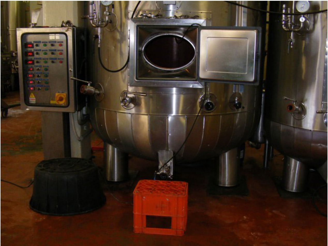
Figura 1: autoclave utilizzata per la fermentazione del vino
