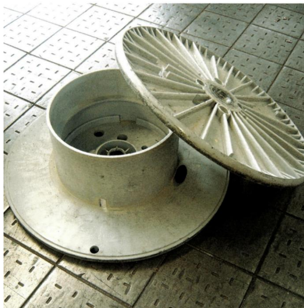
Figura 1: una bobina vuota con la stessa rottura di quella con cavo di rame smaltato rotta durante la dinamica infortunistica.
