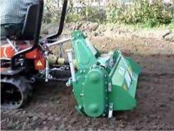
*Illustrazione 1: Esempio di trattore con antiribaltamento posteriore, attaccato ad attrezzatura*
