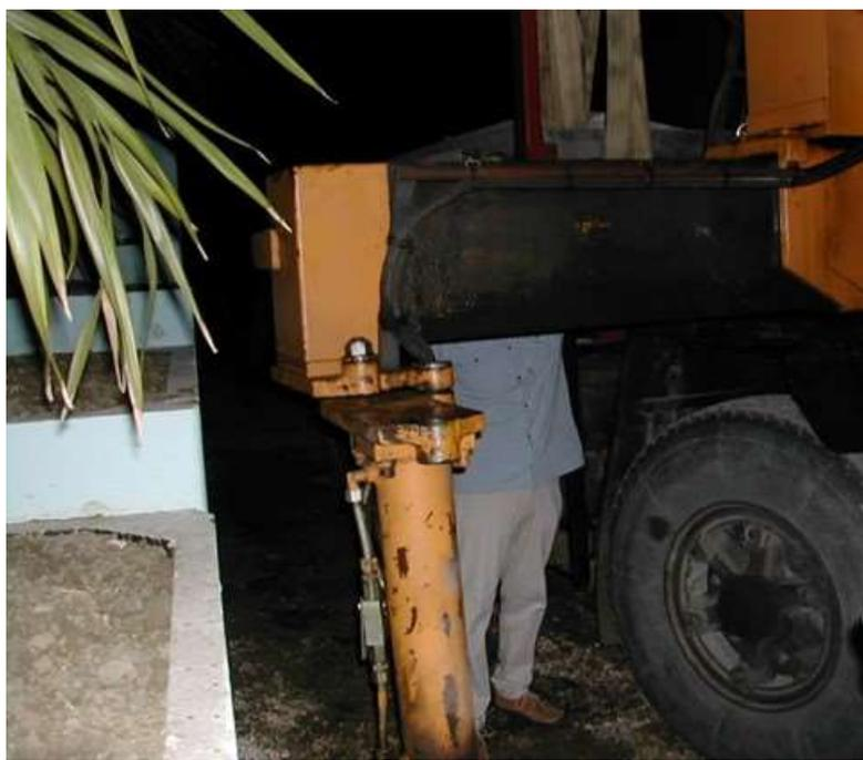
Figura 3. Autogrù con stabilizzatore aperto
