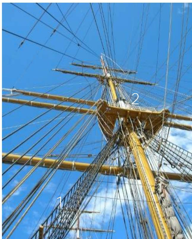
Figura 3. Le sartie e le griselle (1) sono utilizzate dai nocchieri per raggiungere la coffa (2), le barre e i pennoni. I movimenti di apertura e chiusura delle vele, di scorrimento verticale e di orientamento dei pennoni vengono attuati a forza di braccia, impiegando tutto il personale disponibile e
