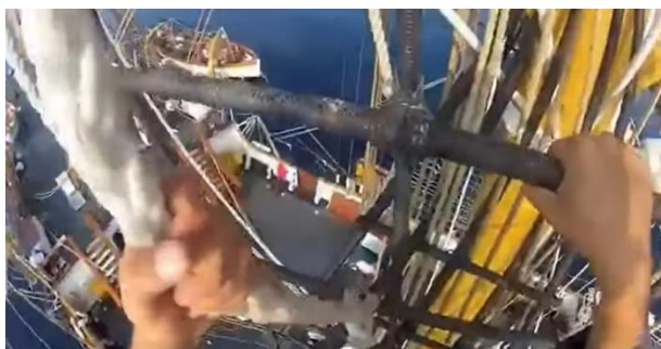
Figura 10. Si notino: l'asta orizzontale in ferro rivestita in cordino per la presa con le mani e l'appoggio con i piedi e il "tientibene", corda intrecciata bianca, laterale ove il nocchiere fa presa con le mani
