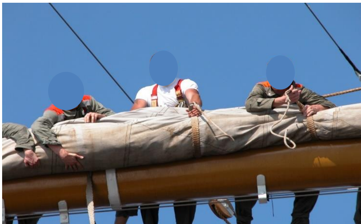
Figura 5. Serraggio delle vele con i matafioni; la pesantezza del tessuto delle vele e la possibilità che esse siano anche bagnate costringe i nocchieri a un notevole sforzo in condizioni di lavoro particolarmente difficili
