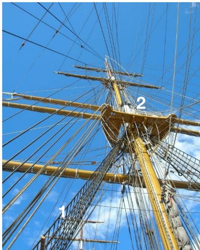
Figura 3. Le sartie e le griselle (1) sono utilizzate dai nocchieri per raggiungere la coffa (2), le barre e i pennoni
