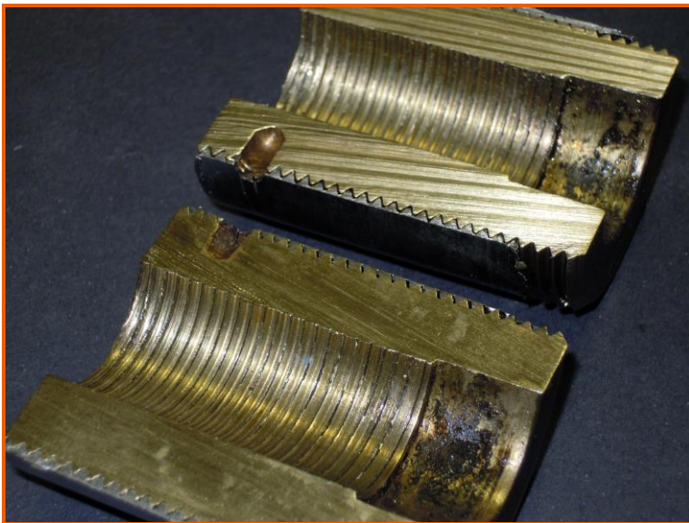
Filettatura di accoppiamento rovinata
