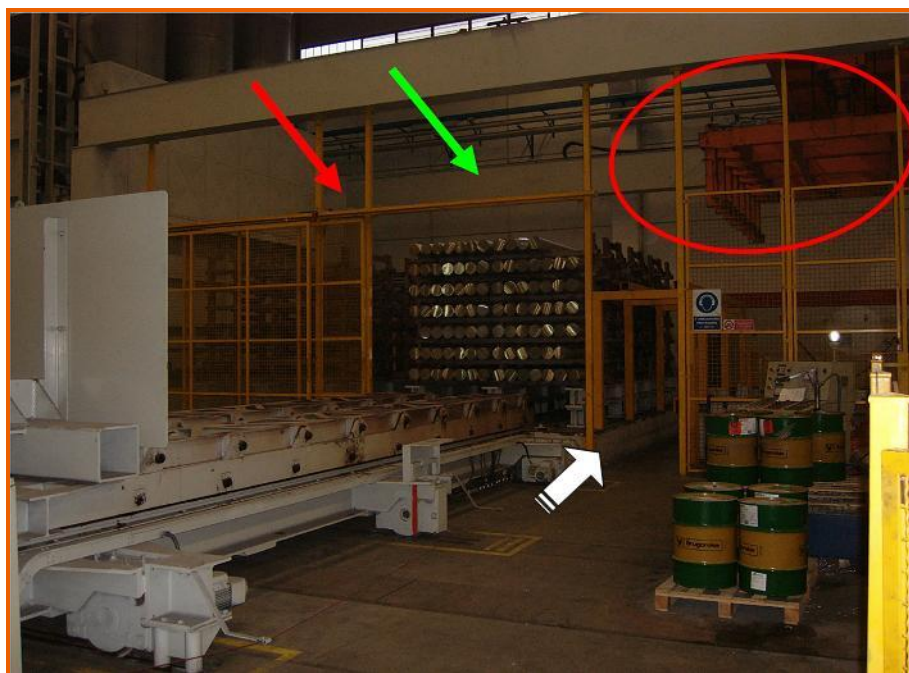
Figura 3: area di preparazione del castello (freccia verde = castello pieno; freccia rossa = castello vuoto); a destra del castello pieno la freccia bianca indica il portale di accesso al retro dell'impianto; indicato in rosso è visibile il carroponte impilatore/disimpilatore di billette
