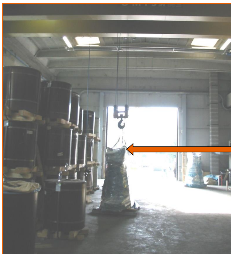
Nucleo di trasformatore agganciato al carroponete
