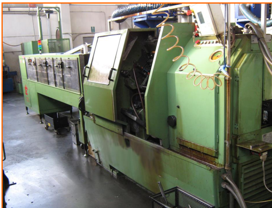
Vista di insieme del tornio (in primo piano) e del caricatore delle barre (a sinistra) che lo alimenta.
