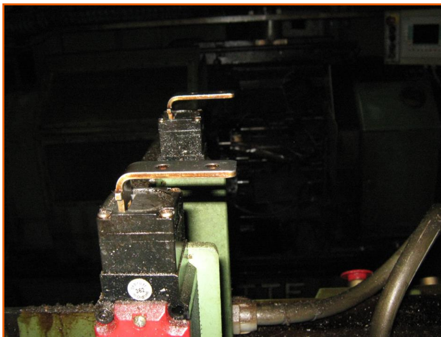
I due microinterruttori di sicurezza, manomessi staccando le due chiavette dagli sportelli e infilando nei microinterruttori.
