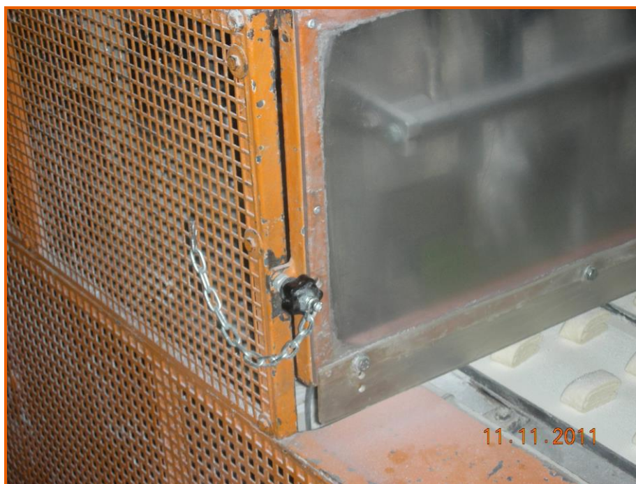
Rotella di chiusura della protezione basculante della linea "piccola"
