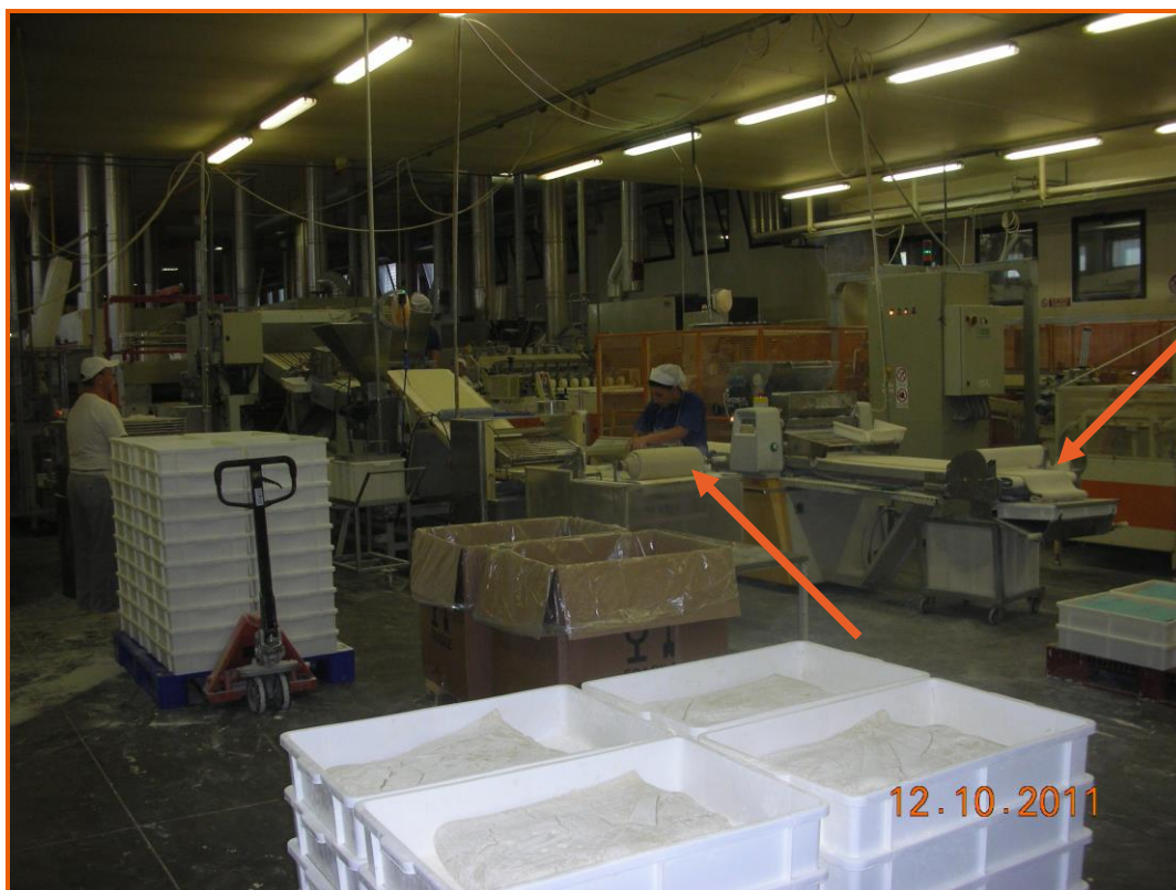
Reparto produttivo dell'azienda Le Dolcezze srl ; le frecce indicano le due linee di produzione con le bobine di pasta che alimentano le linee.
