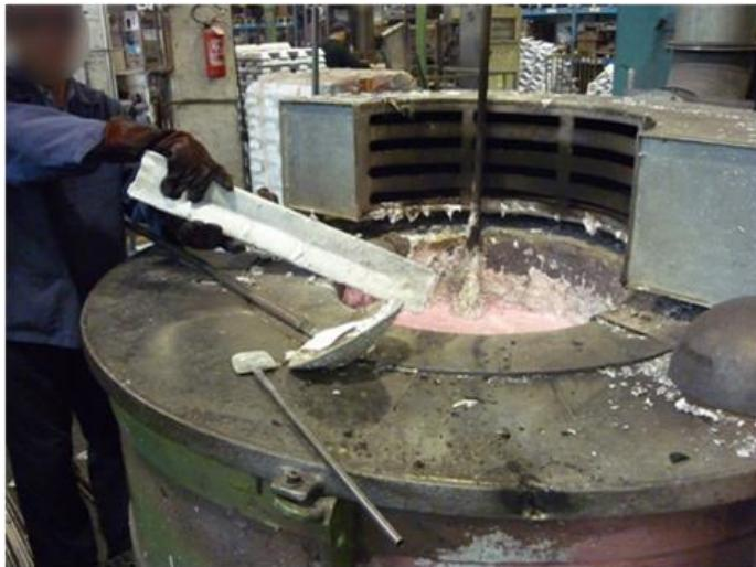
Simulazione inserimento lingotti nel forno
