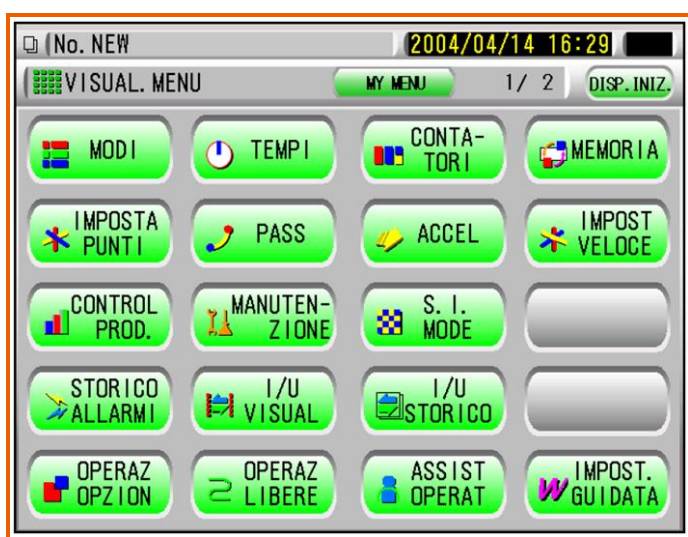
Figura 7: esempio di quadro di comando con pulsantiera digitale contenenti indicazioni chiare della funzione dei pulsanti con colori da norma CEI 44-5.
