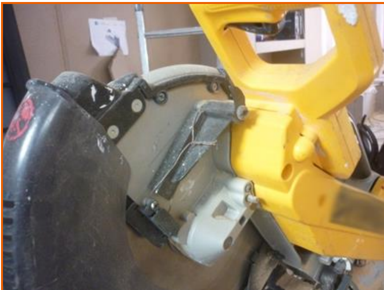
Figura 4: riparazione sulla cuffia di protezione della troncatrice eseguita con fil di ferro.
