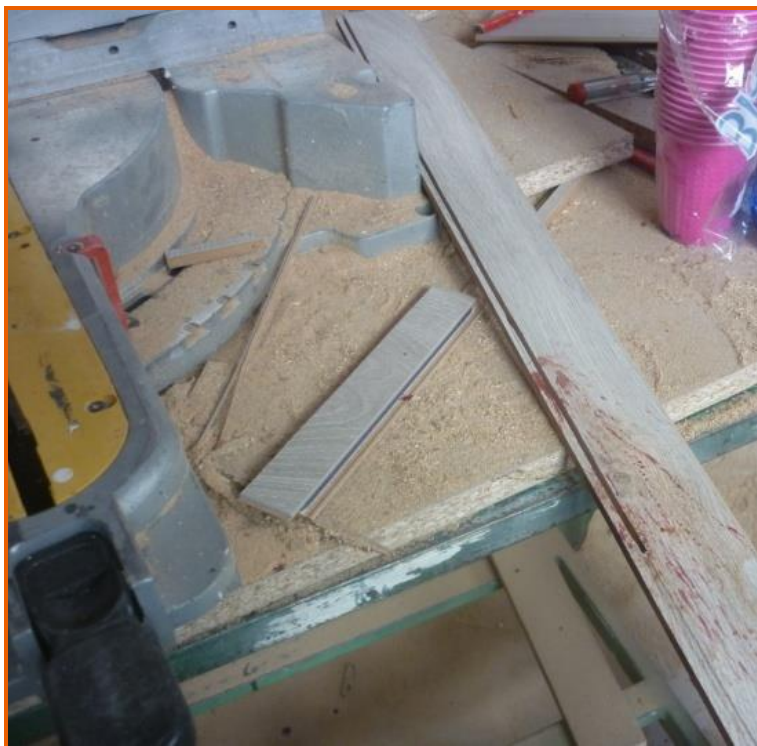
Figura 2: il listello risultava tagliato per un tratto di 55 cm rispetto alla sua lunghezza di 67 cm.
