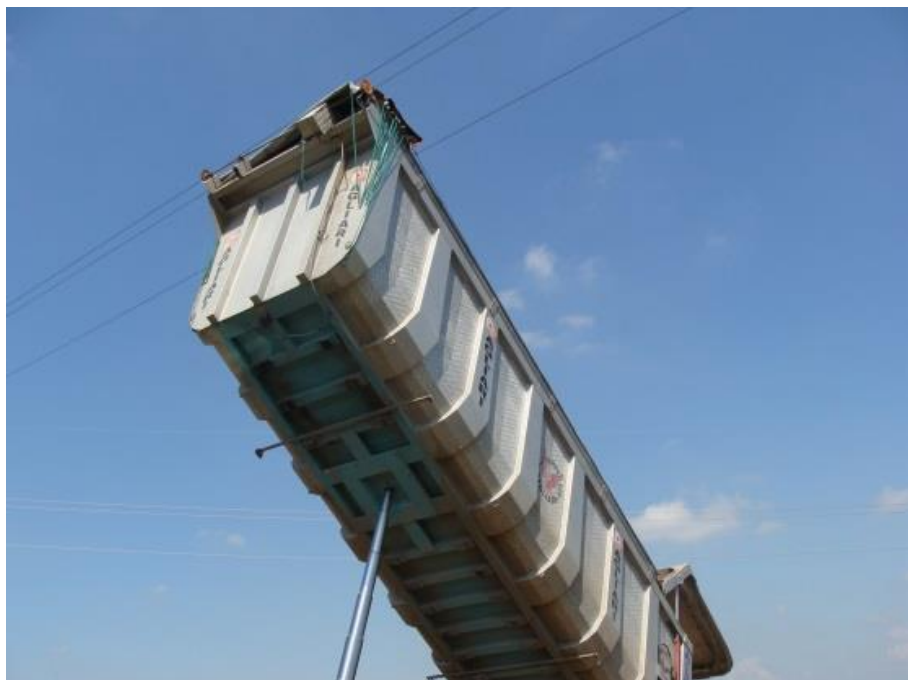
Figura 2: particolare della sommità del ribaltabile a contatto con la linea elettrica da 15 kV
