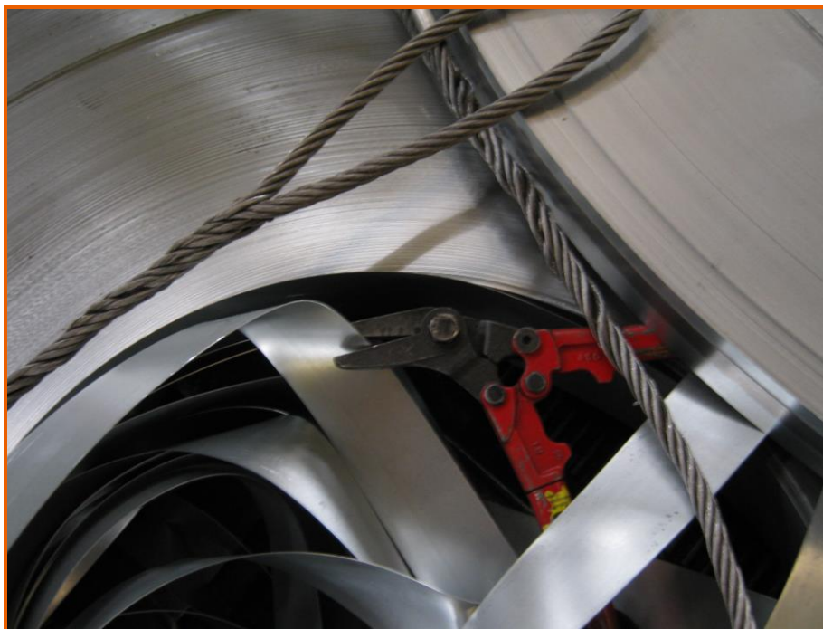
Cesoie utilizzate dall’infortunato per tagliare le spire di lamiera fuoriuscite dal foro centrale del coil prima dell’incidente
