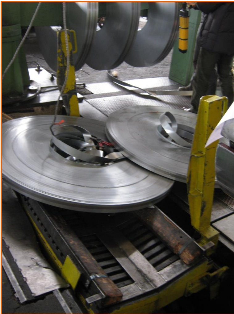
Due coil coricati a terra: uno di essi appoggia sulla culla dove, prima dell'infortunio, si trovava in posizione verticale
