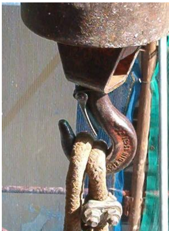
Figura 3: gancio con la molla di chiusura difettosa
