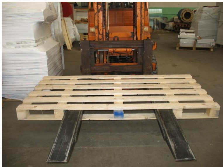
Figura 4. Carrello elevatore e bancale con dimensioni fra loro compatibili
