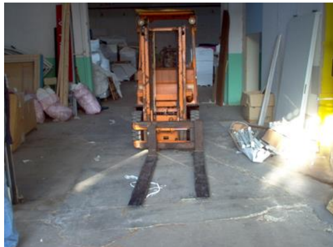
Figura 4. Forca destra non agganciata alla piastra di supporto
