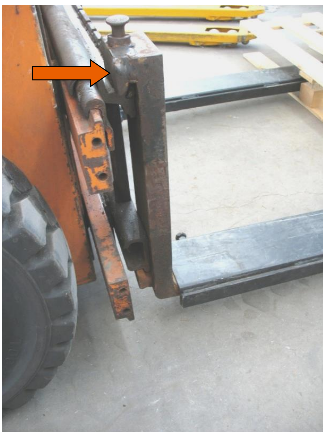
Figura 5. posizione extracorsa della forca destra con l'allestimento di cui alla figura 3
