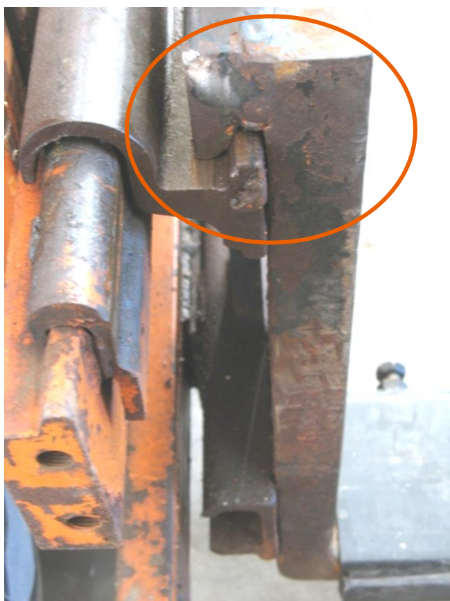
Figura 6. In evidenza la mancanza del fine corsa
