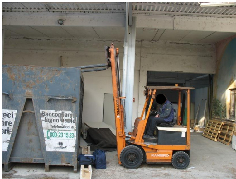
Figura 2. Posizione delle forche e inclinazione del castello del carrello elevatore in fase di scarico all'interno del container; al momento dell'infortunio, il carrello, col suo carico, si trovava tra il pilastro e la parete del deposito
