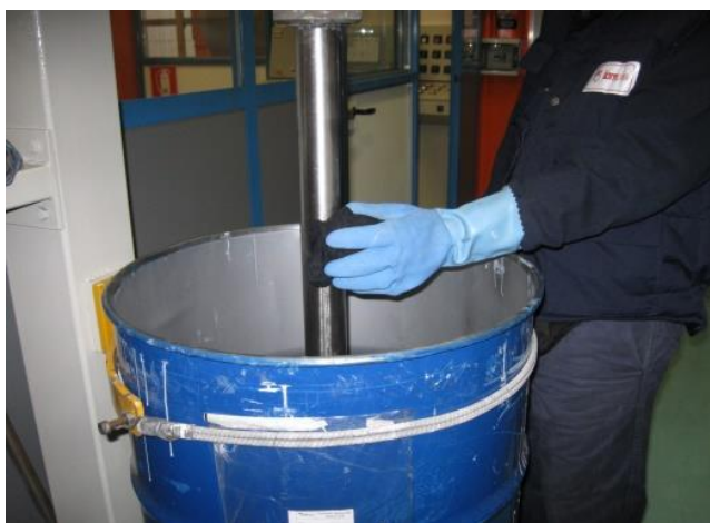
Figura 1. Ricostruzione modalità di pulizia dell'albero in moto
