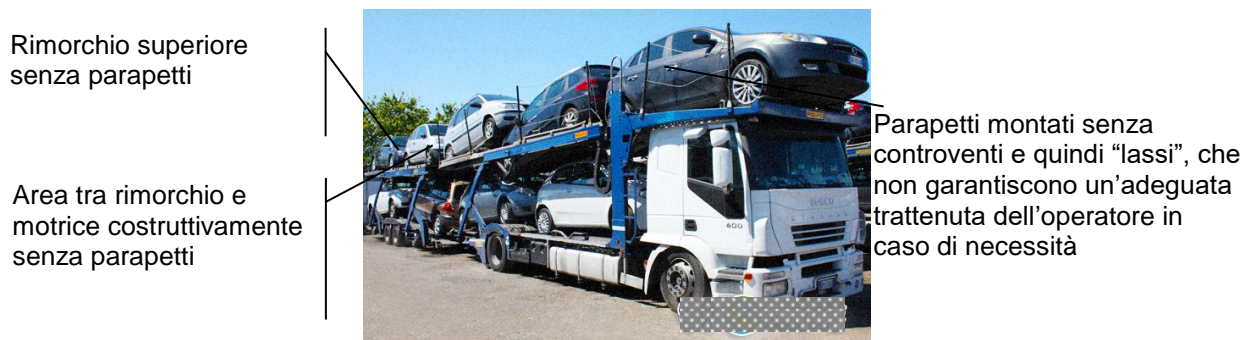
Figura 5. Esempio di bisarca con condizioni pericolose
