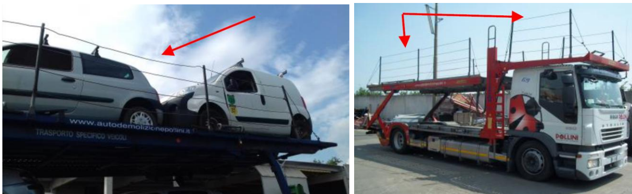
Figura 4. Esempi di montaggio corretto dei sistemi di protezione dei bordi per evitare la caduta dall'alto. Si osservi il corretto tensionamento delle funi che garantisce la "trattenuta" del lavoratore in caso di scivolamento, malore o altra situazione critica.
